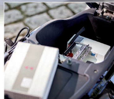
Saft braucht Platz: Der extra große Akku unseres Testrollers kostet ein gutes Stück des Stauraums.
