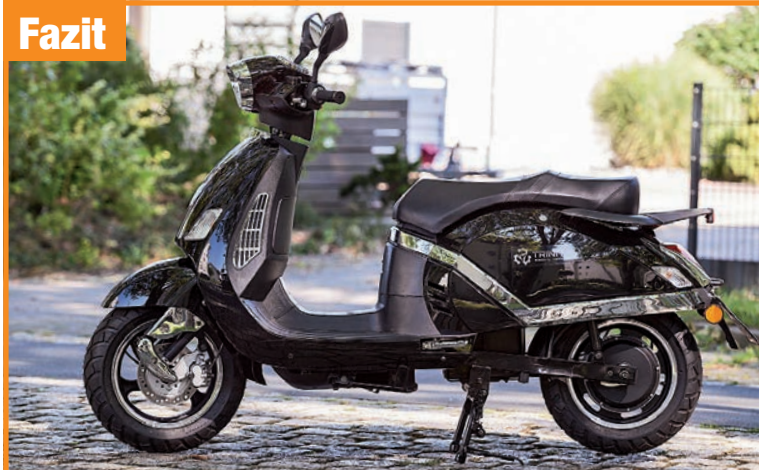
Saft braucht Platz: Der extra große Akku unseres Testrollers kostet ein gutes Stück des Stauraums.
